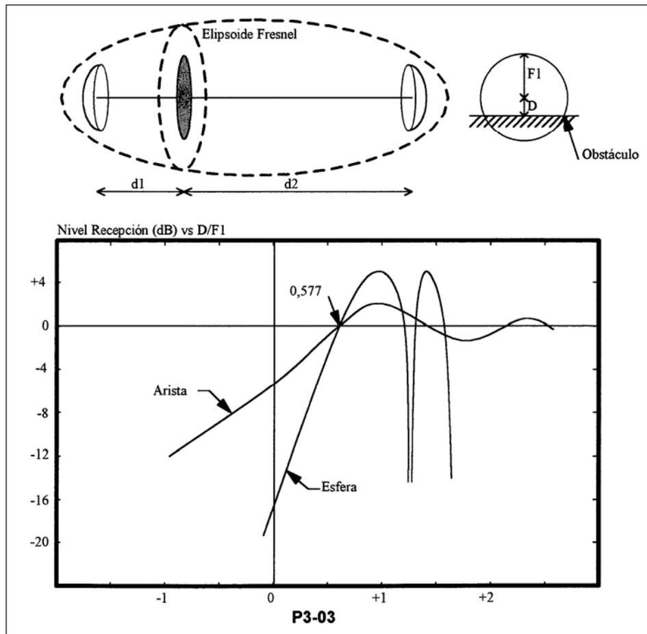
Fig 03. Efecto de la difracción en la atmósfera.
