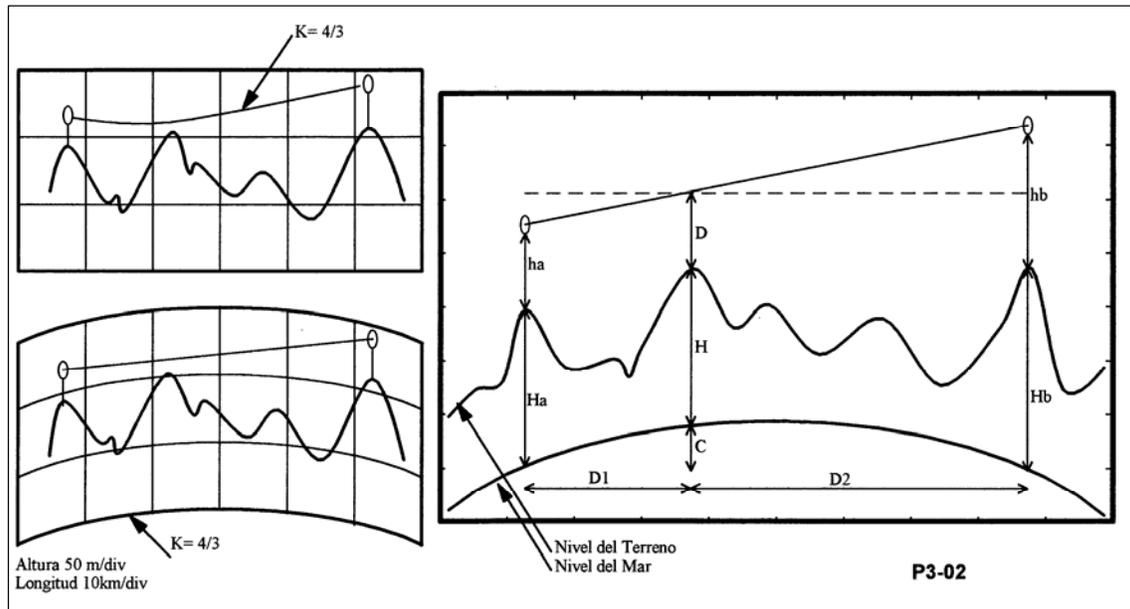
Fig 02. Curvatura del rayo y factor K.
